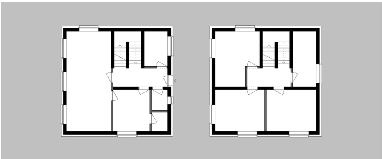
**Abbildung 7.1.1:** Referenzgebäude als Einfamilienhaus (EFH) mit zwei Stockwerken, dargestellt in den Grundrissen für Erdgeschoss und Obergeschoss
