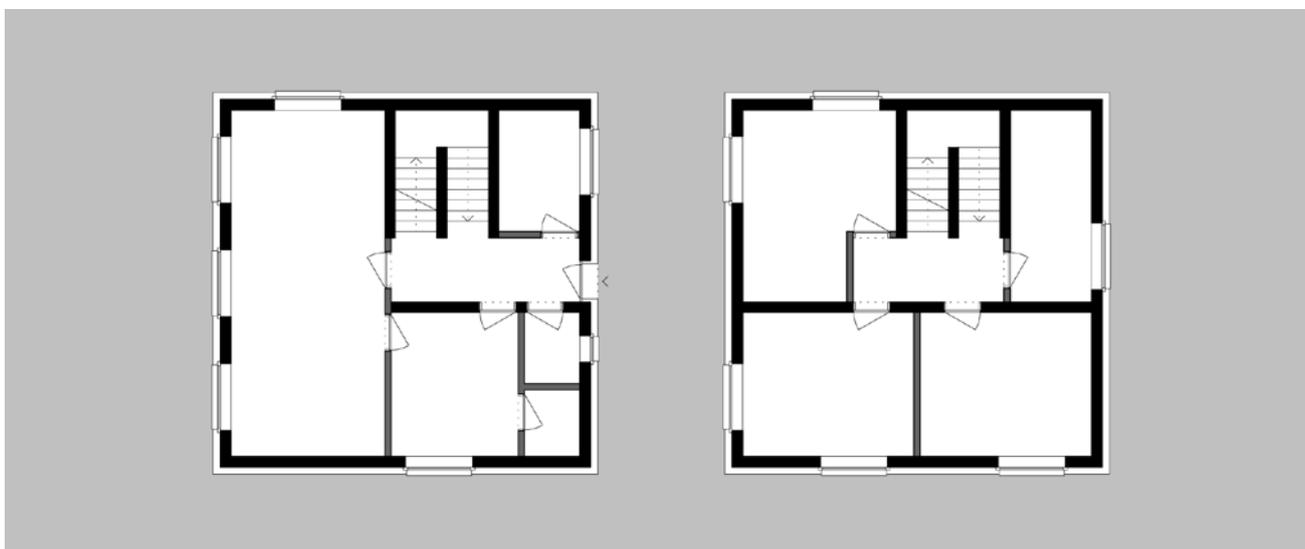
**Abbildung 5.3.1:** Referenzgebäude Einfamilienhaus (EFH) mit zwei Stockwerken, dargestellt in den Grundrissen für Erdgeschoss und Obergeschoss
